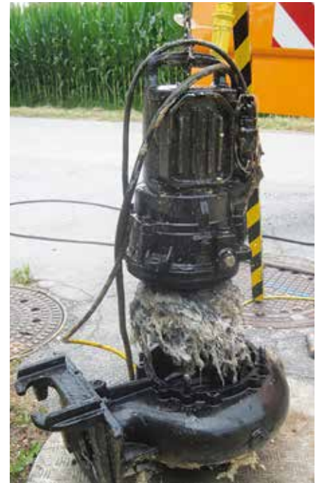
Eine durch Feuchttücher lahmgelegte Abwasserpumpe
