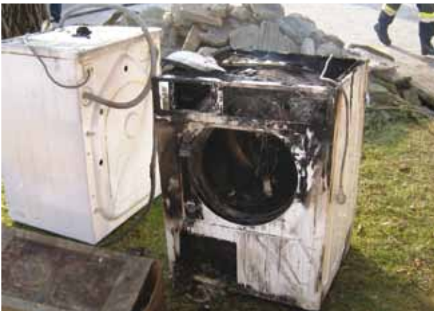
Vermutlich löste ein defekter Wäschetrockner den Brand aus
